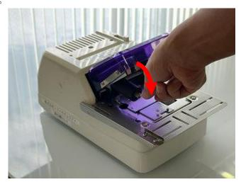
④ 古いローラーを取り出す。直接触れると手が汚れるため、空のインクローラーケースなどを使用する。
